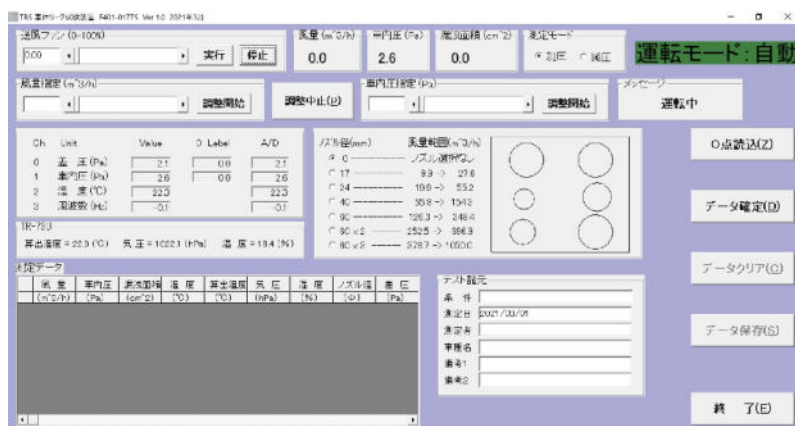
車体漏洩試験システム
