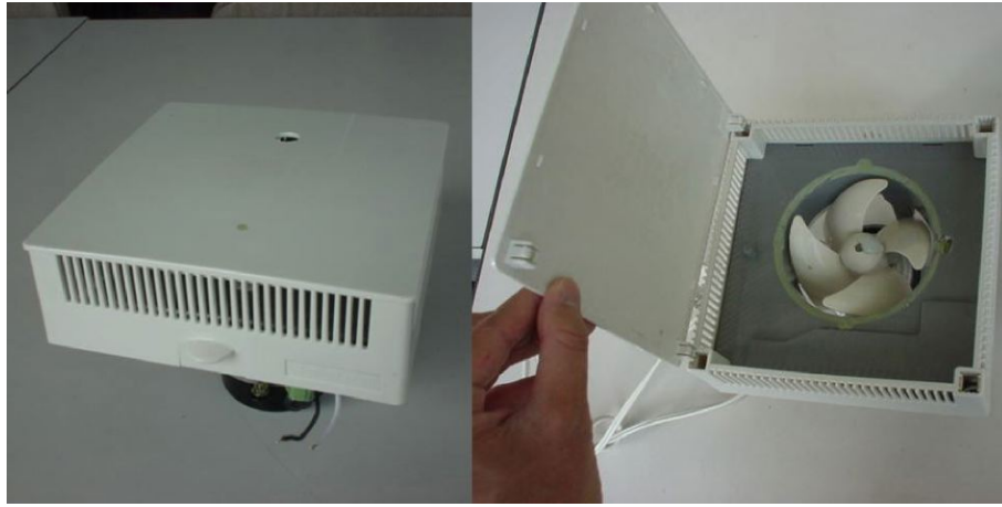
図 1: 実験に使用した換気扇。左図がグリルをつけた状態。グリルの丸い穴は回転数を測定するために空けてあり、実際の製品は空いていない。右図はグリルをあけた状態。4面ある側面それぞれに吸気口が空いている。
