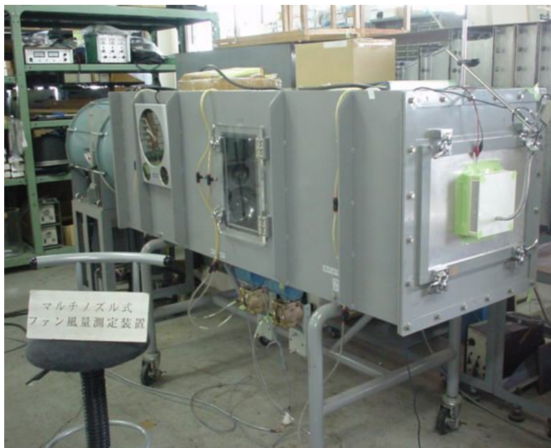
図 7: ファン風量測定装置。換気扇の P-Q 曲線を測定できる。
