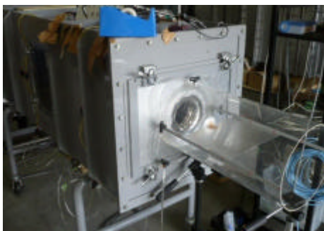
図 4 マルチノズルファン風量測定装置
